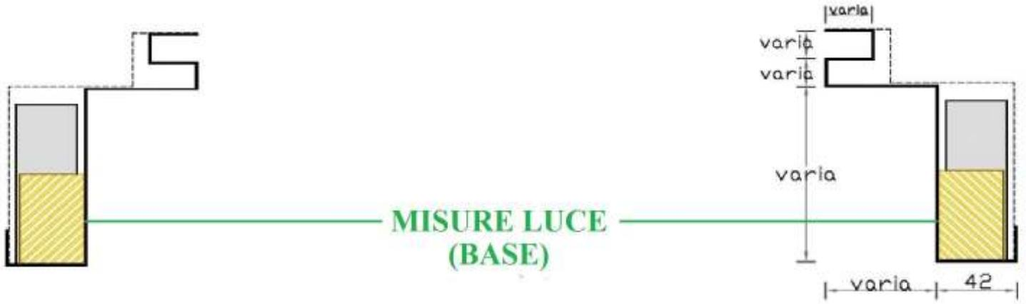
Di base il falso telaio STT viene fornito con cassetta per avvolgitore. Nel caso le avvolgibili fossero motorizzate indicare . Di conseguenza il falso telaio sarà fornito senza cassetta.
