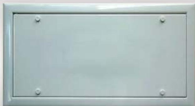
Materiale : alluminio sp. 1.5mm piegato , saldato e molato per essere poi verniciato a polvere di poliestere. Guarnizione di battuta 3 x 15 mm tra sportello e telaio
