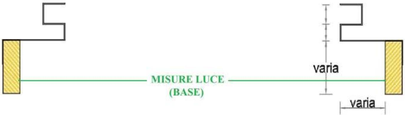
Di base il falso telaio STC viene fornito con cassetta per avvolgitore. Nel caso le avvolgibili fossero motorizzate indicare . Di conseguenza il falso telaio sarà fornito senza cassetta.
