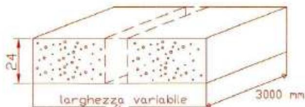
Pannello dallo spessore di 24 mm con lunghezza 3 metri e di larghezza variabile a seconda delle esigenze, assemblabile con art. 796.
