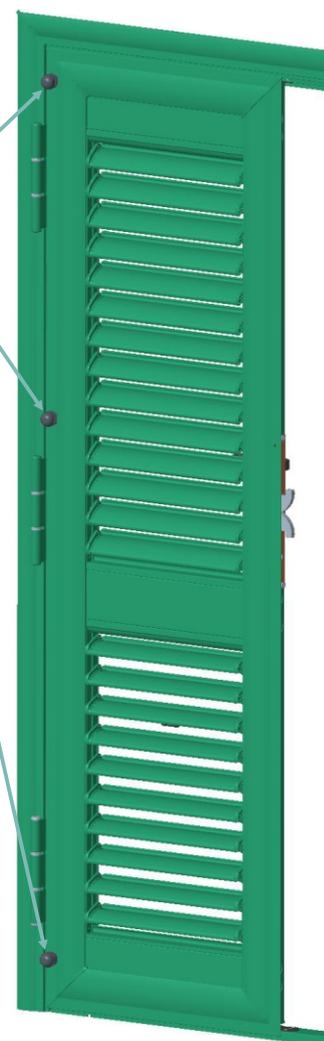
Si consiglia di fissare il gommino anti-urto a circa 10 cm da ogni cerniera; per cui, fissare n.3 spessori per il porta-finestra e n. 2 per la finestra.
