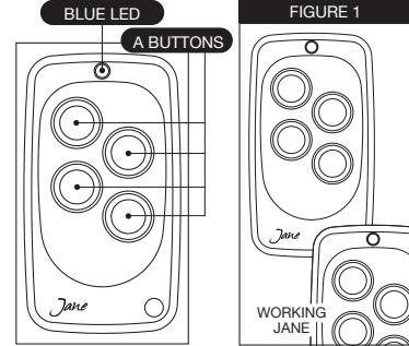
**JANE F** - Radiocomando che copia in autoapprendimento codici fissi con frequenza **433.92 MHz** per ogni singolo canale.
